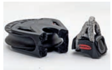
Im ersten Test brach der Ronstan Orbit schon bei rund 850 Dekanewton Last
